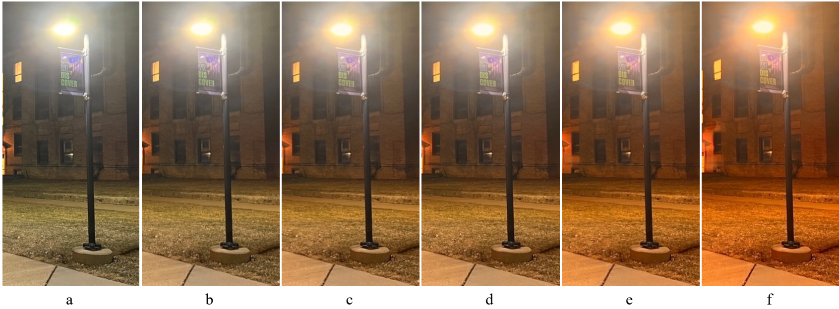
Figure 3.3 Simulated spectrum alternatives. a) 5000K. b) 4000K. c) 3000K. d) 2700K. e) 2200K. f) amber (~1800K).
