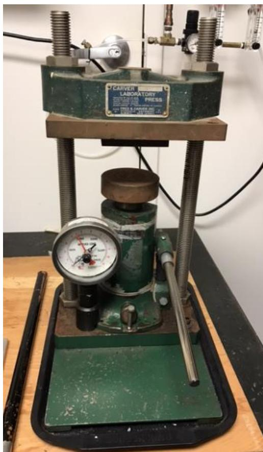
Fig 3.7. Pellet press assembly
