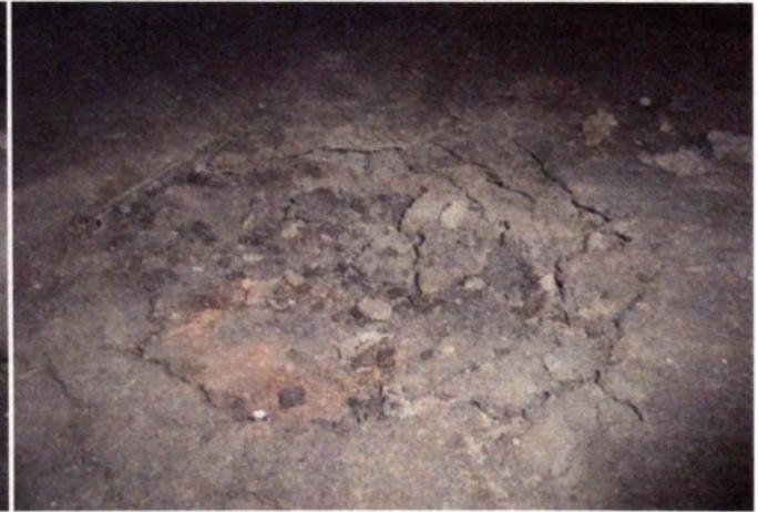
(d) Cratering in Compression Face
