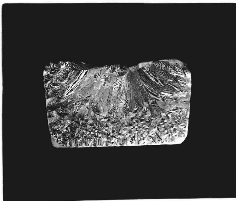
Fig. 40 Cd-Zn eutectic 1.75x
