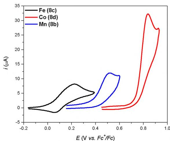
Figure 8. Cyclic Voltammograms (M<sup>II</sup>/M<sup>III</sup> Redox Couple)
