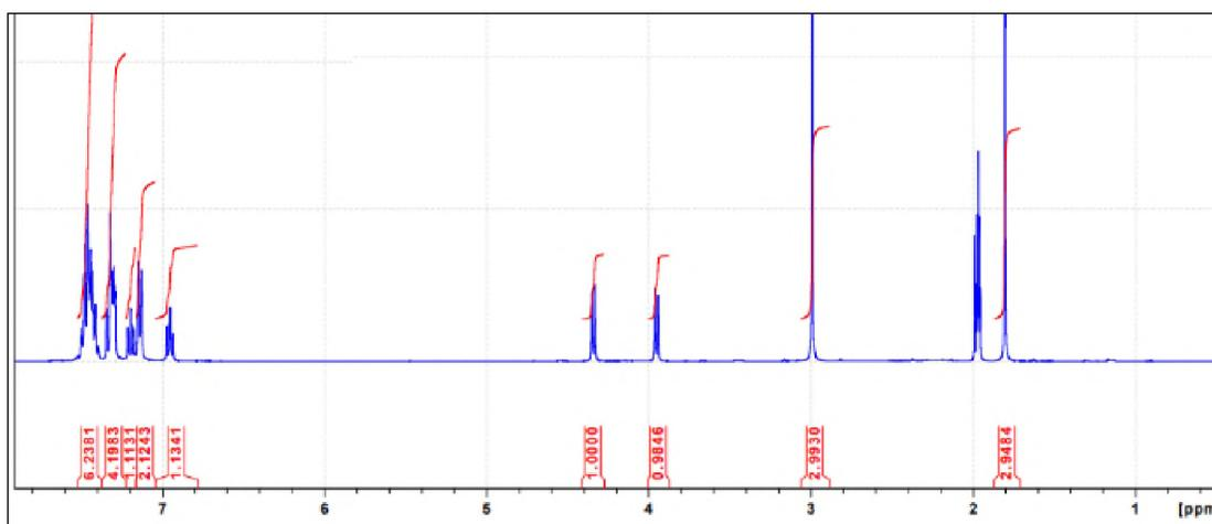
Figure 6.  $^1\text{H-NMR}$  (400MHz) of **12** in  $\text{CD}_3\text{CN}$
