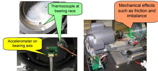
**Fig. 4. Motor Testbed**
