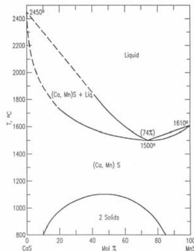
**Figure 19:** Binary MnS-CaS phase diagram<sup>13</sup>
