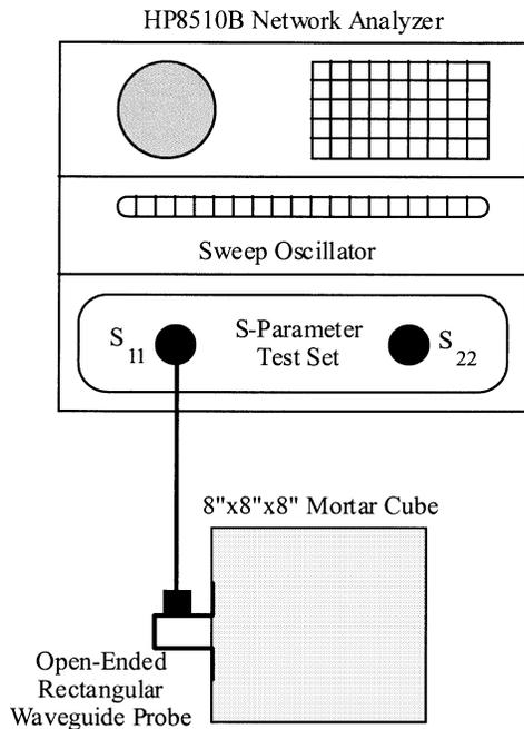
Fig. 1. Measurement apparatus.
