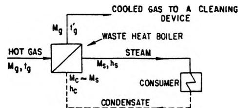
FIG. 11: UTILIZATION OF WASTE HEAT FOR GENERATION OF STEAM
