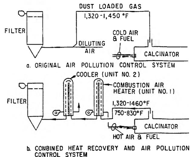
FIG. A1: ONE EXAMPLE OF COMBINED HEAT RECOVERY AND AIR POLLUTION CONTROL SYSTEM IN A KAOLIN PLANT
