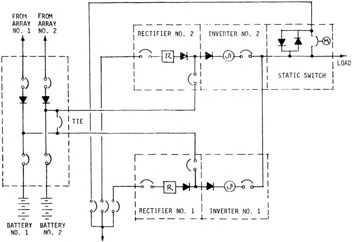
FIGURE 7. POWER CONDITIONING SYSTEM
