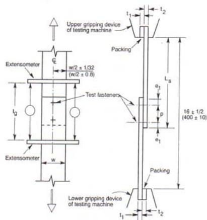
**Figure 3. Elemental Test Setup (*Cold-Formed*, 2003)**
