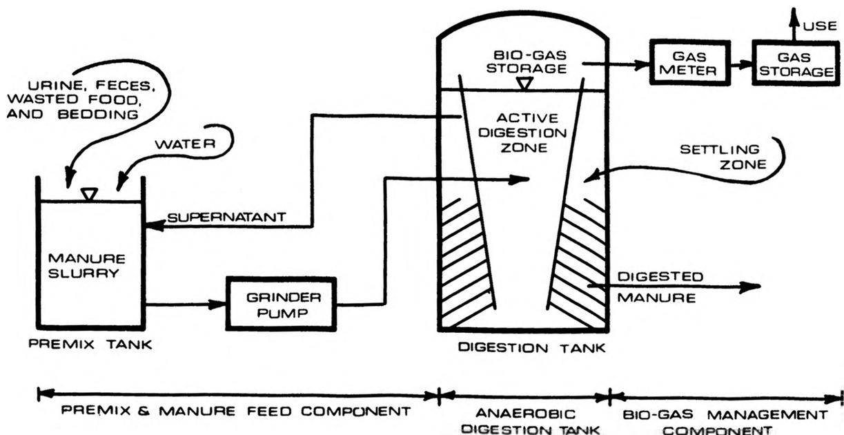
SCHMATIC OF ANAEROBIC DIGESTION SYSTEM
