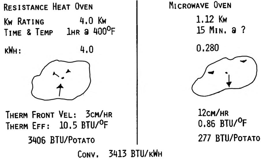
FIGURE 2 CHARACTERISTICS OF MICROWAVES
