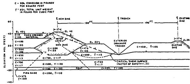
FIGURE 5-SOIL PROFILE AND DIKE STABILITY-STAGE 2
