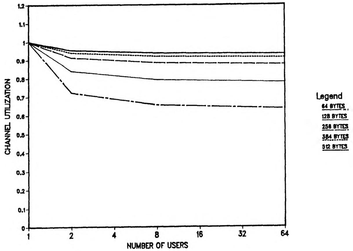
FIGURE 18 - UPDATED XEROX EFFICIENCY CURVE
