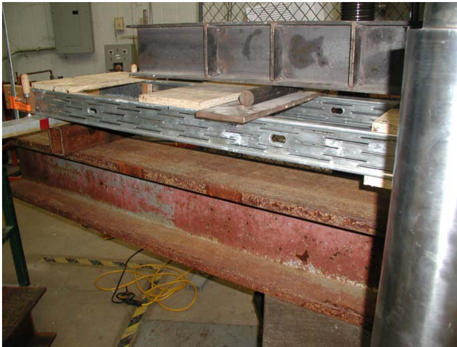
Slit-Web Stud Bending Test Setup
