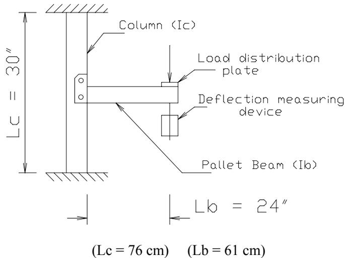
Figure 9.4.1.1-1 Cantilever Test
