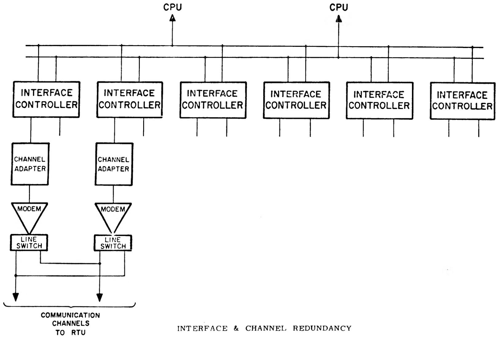
INTERFACE & CHANNEL REDUNDANCY
