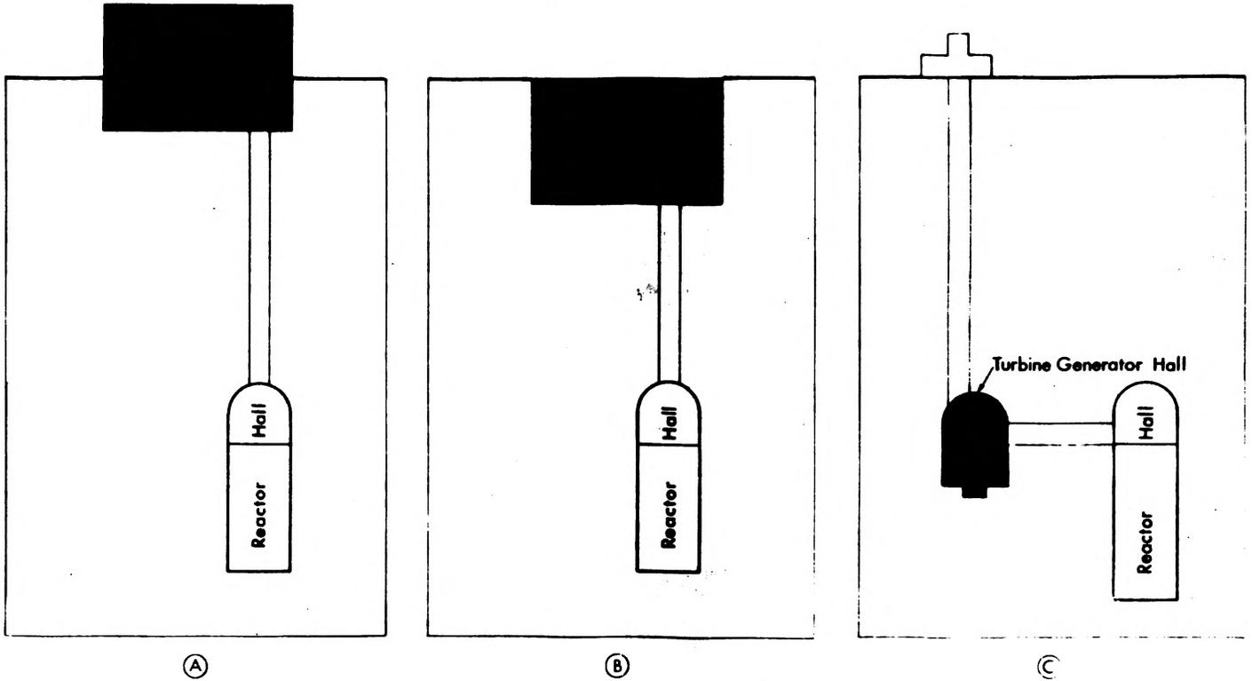
FIG. 2 SCHEMATIC ARRANGEMENT-UNDERGROUND FACILITIES
