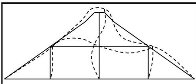
Figure 2d: 3<sup>rd</sup> Mode (Rocking)
