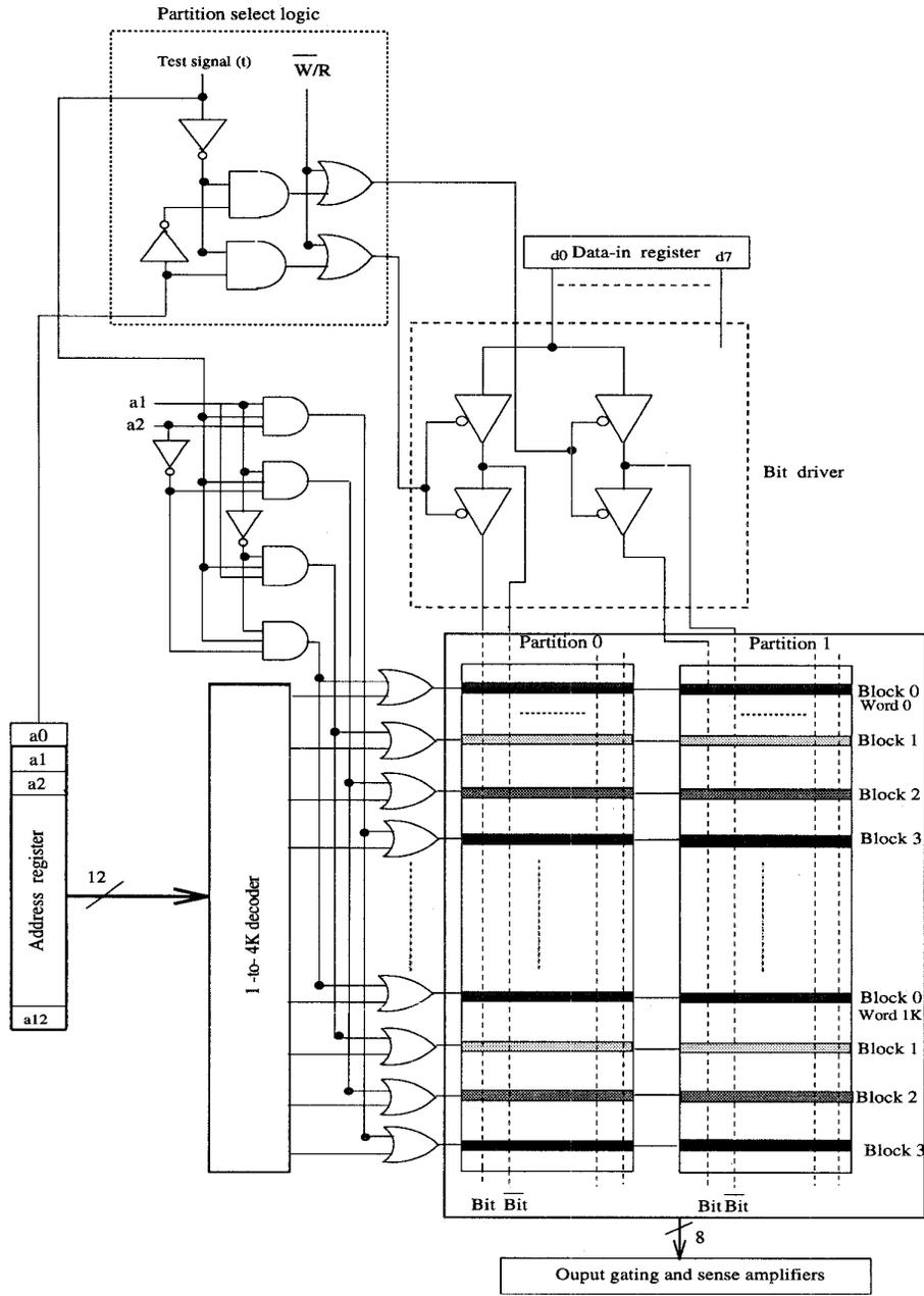
Figure 3: The  $I_{DDQ}$  8K X 8 testable SRAM
